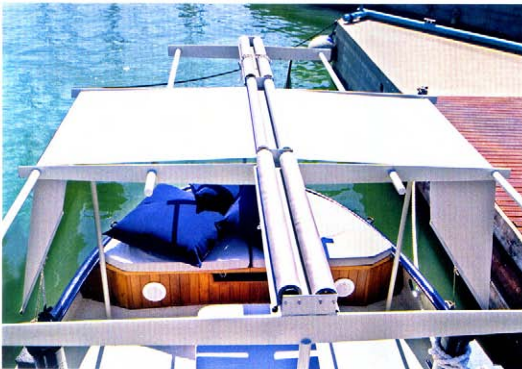
Sopra il meccanismo del tendalino "a giunca" ideato dall'arch. Braguglia. Sotto, il pozzetto con il tavolo pouf e il prendisole di poppa. Nella pagina a fianco: I struttura che sorreggeva i teloni, che ha ispirato il tendalino, il verricello e il pozzo della catena, la plancia.
